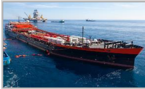
HOS Centerline , our first of two 370-ft U.S.-flagged DP2 HOS 370 class MPSVs
